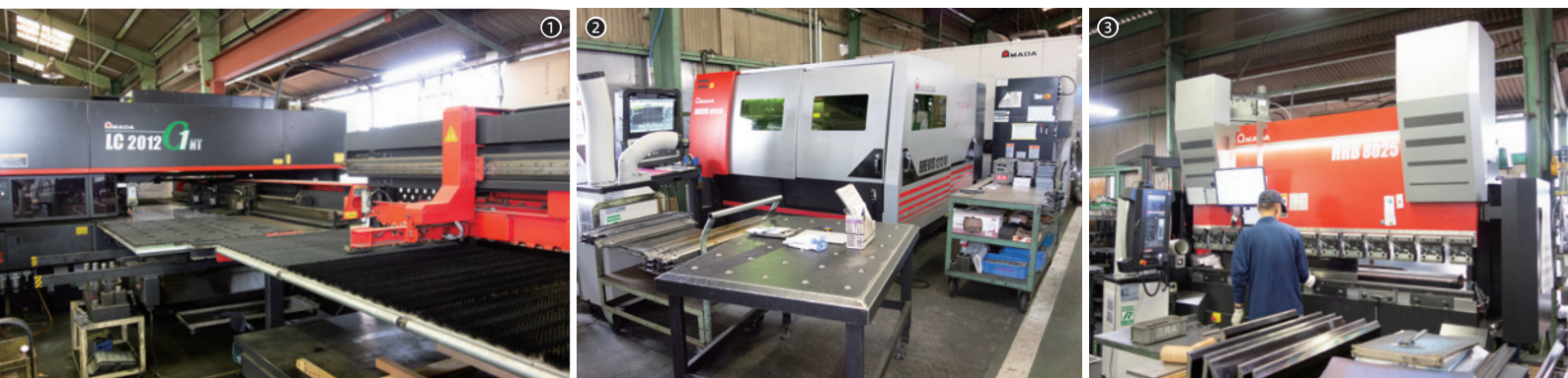
①パンチ・レーザ複合マシンLC-2012C1NT（マニプレーター仕様）／②コンパクトファイバーレーザマシンBREVIS-1212AJ／③ベンディングマシンHRB-8025による曲げ加工。上部テーブルにモニターを設置し、図面を閲覧できる
