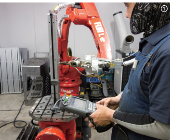
①ティーチングペンダントによるFLW-Leのティーチング作業／②FLW-Leで溶接したファンシュラウド／③FLW-Leで溶接したファンガード（修正なし）
