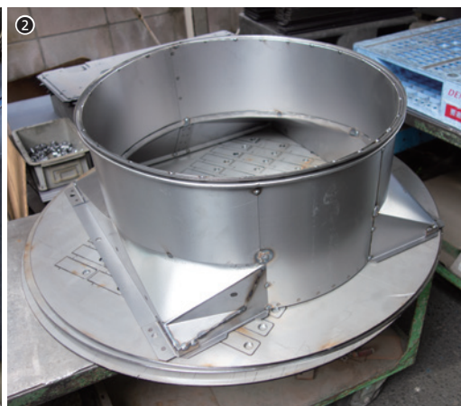
①ティーチングペンダントによるFLW-Leのティーチング作業／②FLW-Leで溶接したファンシュラウド／③FLW-Leで溶接したファンガード（修正なし）
