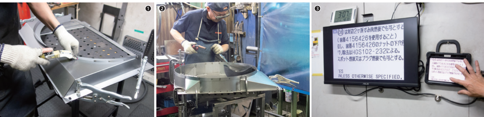
①ハンディファイバーレーザ溶接機 FLW-600MT による溶接作業／②溶接工程。TIG 溶接や半自動溶接も得意としている／③現場にモニターを設置しているほか、タブレット端末を全社員に配布し、可視化を進めている
