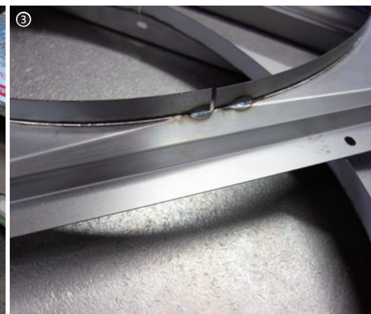
①ティーチングペンダントによるFLW-Leのティーチング作業／②FLW-Leで溶接したファンシュラウド／③FLW-Leで溶接したファンガード（修正なし）
